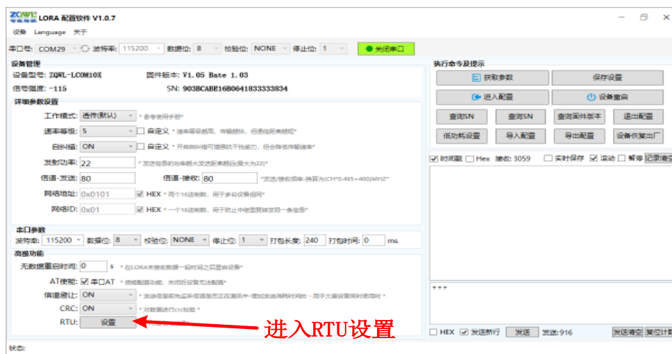
图 2-6 进入 RTU 设置
