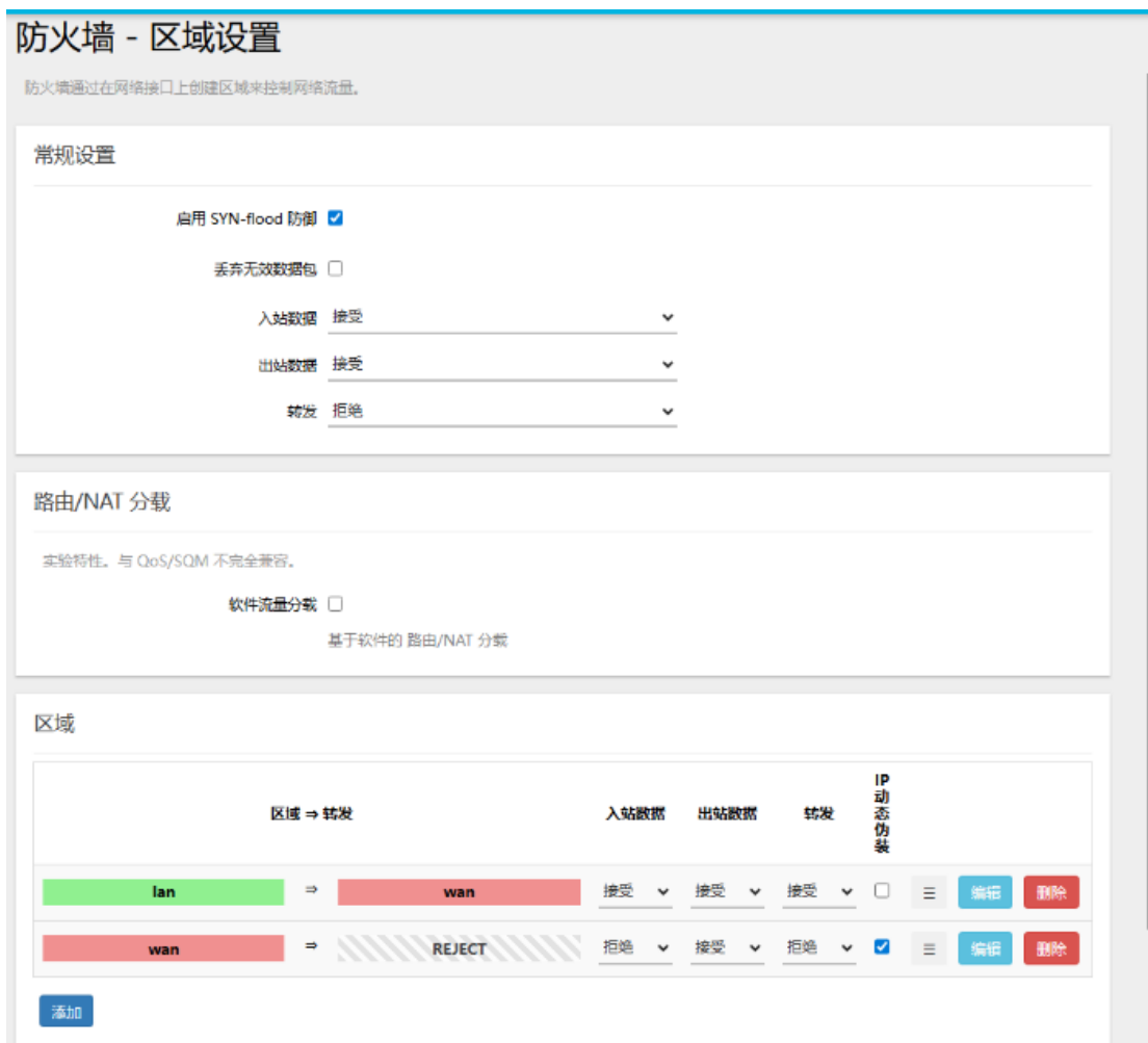
图 5.12 防火墙常规设置
